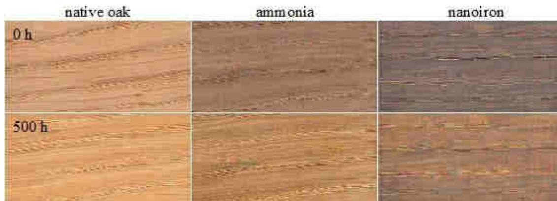
Natúr tölgy, ammóniával kezelt tölgy és nano-vassal kezelt tölgy az 500 órás mesterséges napfénnel történő megvilágítás előtt és után
