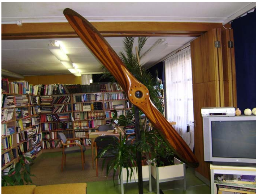
Egy későbbi légcsavar. Hossza: 290 cm, vastagsága: 210 cm, rétegek száma: 11, anyaga: kőris, mahagóni, tengely furat átmérője 9 cm, külső közép átmérő: 21 cm. Beégetett felirat (részlet): SZ 500 LE
