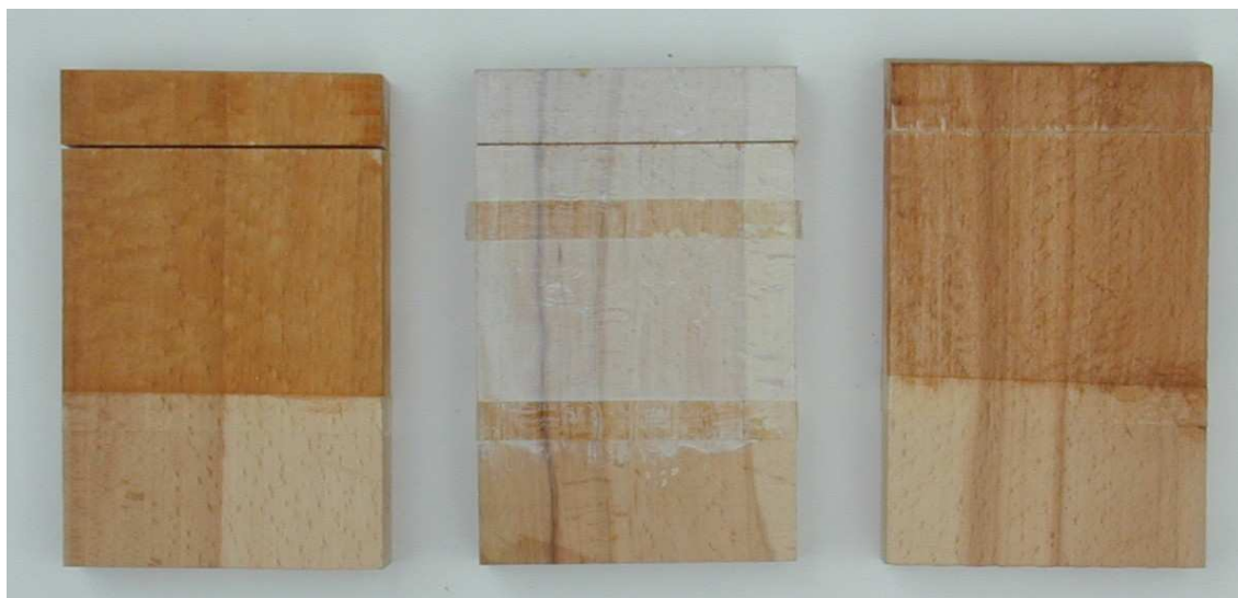
12.sz. kép. Pácolt felületek fényállósága (keskeny, levágott csík az öregítés előtti színt mutatja)
