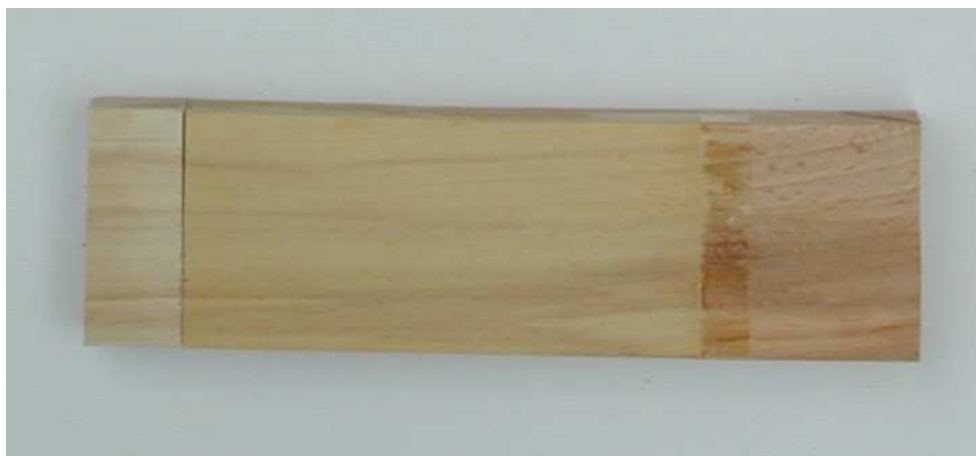
8.sz. kép. Fehérített minták fényállósága [a keskeny levágott csík az öregítés előtti színt mutatja]
