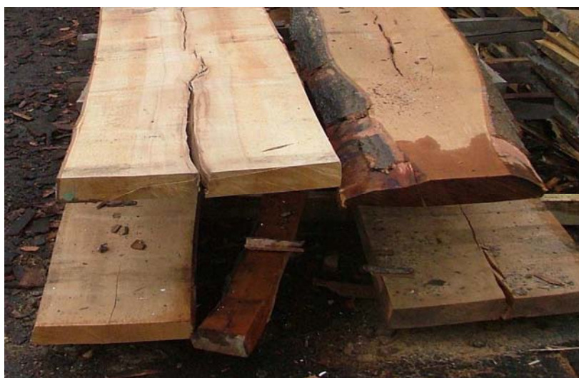
6.sz.kép. Jellegzetes, álgesztes -bél mentén végighasadt- fűrészáruk
