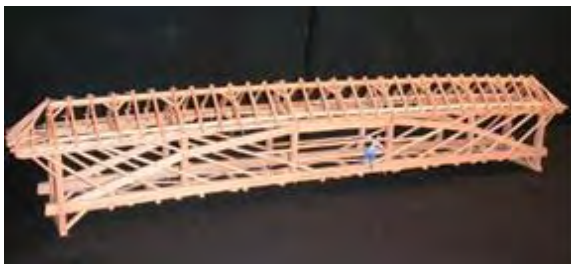
16. ábra. – A Thur híd modellje kombinált tartószerkezettel
